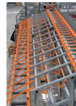
15. SDS: Накопитель с 2 пневматическими плечами для хранения, перемещения прутьев и их последующей передачи на гибочные линии.
