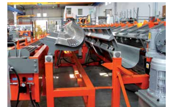
16. Опрокидывающий карман: Принимает прутья из магазина, и опрокидывает их на конвейер гибочного робота.
