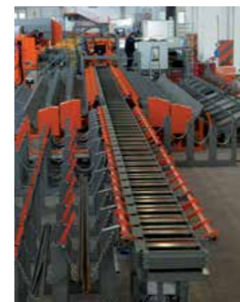
14. VS: Разгрузочная дорожка, служит для получения прутьев от канала измерения и перемещения (VMT) и их последующей передачи в секции хранения.
