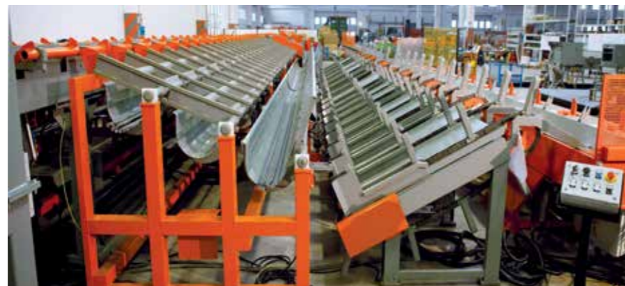
4. POCKET: Накопитель карманного типа выполненный в виде лотка со звукопоглощающим покрытием. Оптимизирует накопление и отгрузку стержней, позволяет независимую загрузку и загрузку любого лотка.
