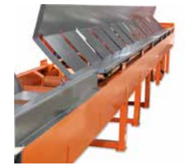
10. VRP: Стационарный роликовый транспортер с приводными роликами. Используется для промежуточного накопления стержней, торцевой, а также фронтальной выгрузки направо и налево.
