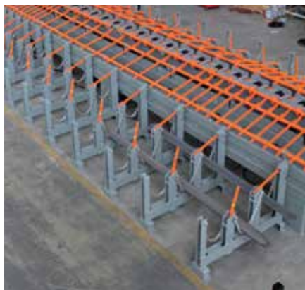
3. RACK: Секционный накопитель, позволяющий накапливать отрезанные стержни и связывать их в пучки. Применяется в том случае, если последующая обработка не предлагается.
