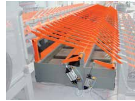
8. T: Стационарный роликовый транспортер, позволяющий формировать пачки стержней и перемещать их для последующей обработки.
