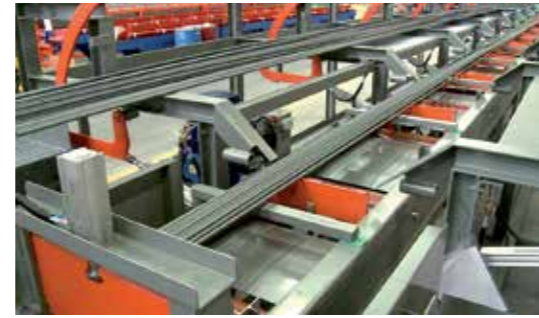
2. VA: Система предварительного секционного хранения с вращающимися плечами на подающем конвейере.
