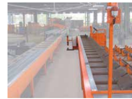
9. CC: Фронтально перемещающийся по рельсам роликовый транспортер с одним отсеком, служащий для промежуточного накопления стержней, торцевой выгрузки, а также фронтальной выгрузки стержней на пол для формирования пачек по заказам.
