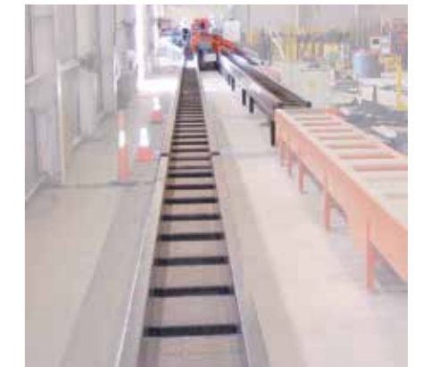
13. PT: Роликовый конвейер. Позволяет передачу по длине пучков арматуры.
